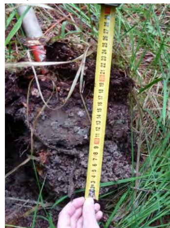
Séparation des horizons supérieur et inférieur d'un prélèvement de sol
